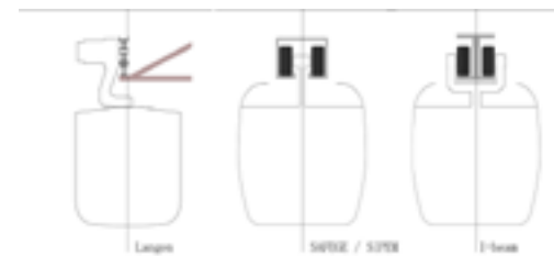
Рисунок 2 – Монорельсовая система по способу подвеса состава
